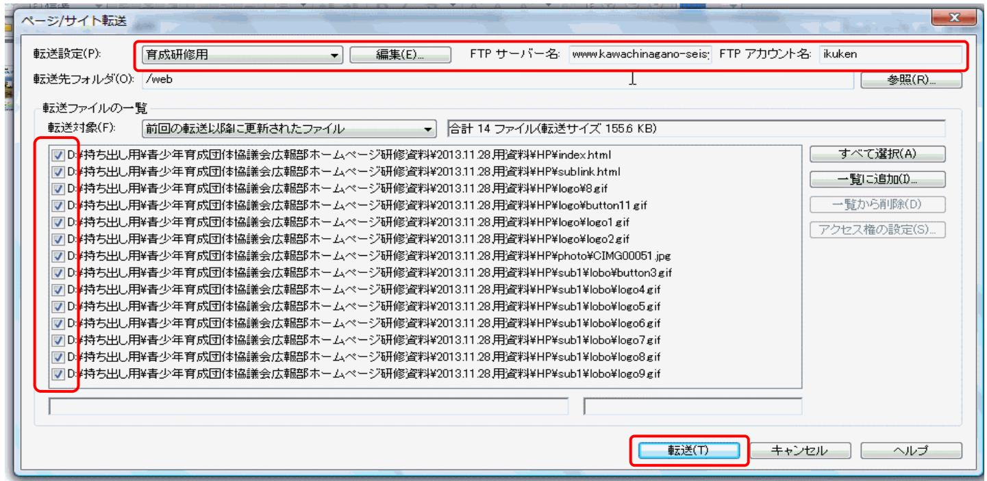
サーバーの最新データをダウンロードする方法は、サイトをクリック→転送設定→サーバー上のファイルのダウンロードをクリック→右下の画面が開いたら、転送設定のホスト名を確認して、参照をクリックしてパソコンの保存したい場所を選んで、OKをクリックするとダウンロードされますので、このファイルを使ってホームページの修正・更新を行ってください。
